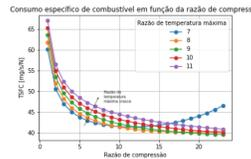
(c) Pós combustor desligado
